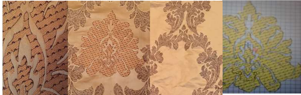
التصميم على شاشة Wilcom العينة قبل التطريز العينة بعد التطريز زوم لشكل الغرز شكل (٢١)
